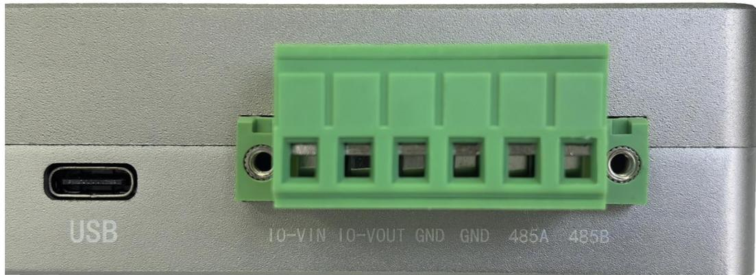
**USB:** Type-C 供电和通讯接口，供电范围 4-6.5V，采用 C to C 线可支持手机供电，耗电为 300mA。
