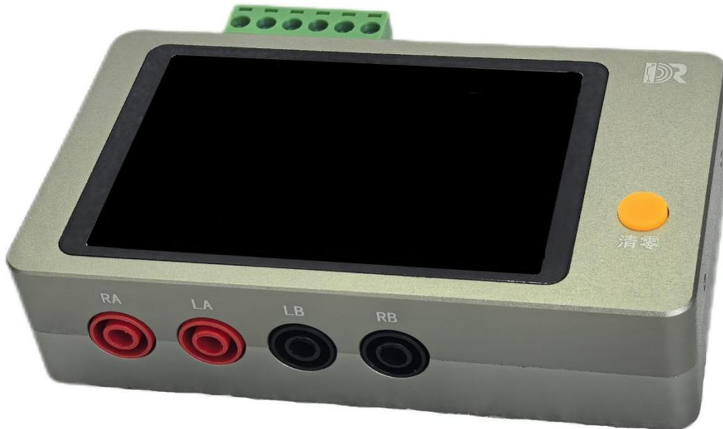
DRL2411 电感测试仪是基于 LC 自然谐振原理而设计，对其内置电容器 C 充电后与被测电感 L 进行物理谐振，再测量其频率，通过计算公式： $F = \frac{1}{2\pi\sqrt{LC}}$  计算出结果。
